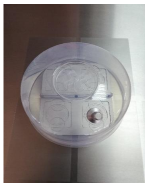
Figur 11.8 Gasudløbet skal placeres over gasdysen
